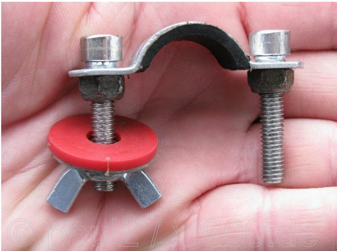
**Halbzollschelle.** Flügelmuttern und Karosseriescheibe mit Gummi aus Bierflaschendeckel (verhindert das Eindringen von Wasser durch die Montagelöcher). Die Koffer sind dank der Flügelmuttern in wenigen Sekunden an- und abgebaut. Köpfe der Inbusschrauben können später runtergefeilt werden (Diebstahlschutz).
